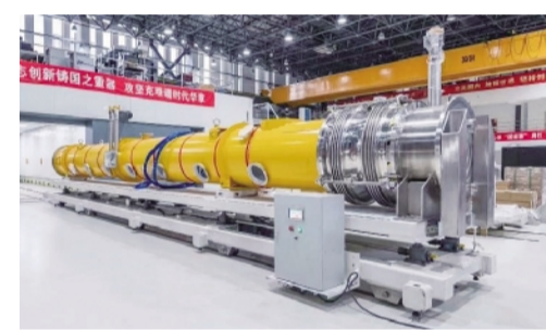
1.3 GHz 9-cell 超导加速模组总装。中国科学院高能物理研究所供图
